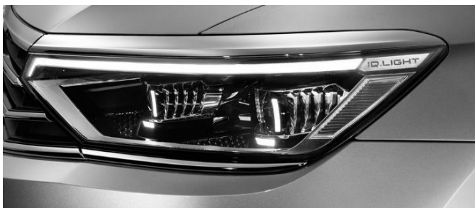
Abbildung 3: IQ.LIGHT LED-Matrixscheinwerfer mit sichtbarem IQ.LIGHT Logo [1]
