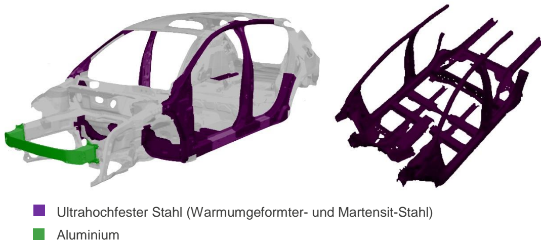
Abbildung 1: Verbau von Aluminium und ultrahochfesten Stahl in der Karosseriestruktur Ford Focus (CGE) [1]
