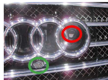
Abbildung 20: Kühlerabdeckung mit Umfeld- kamera (grüne Markierung) und Infrarotkamera (rote Markierung)
