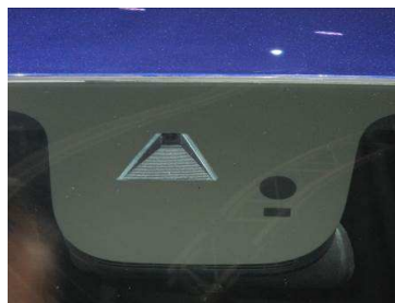
Abbildung 19: Hinter Windschutzscheibe montierte Monokamera mit Streulichtblende und Regensensor
