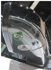
Abbildung 21: Umfeldkamera an der Unterseite des Außenspiegels
