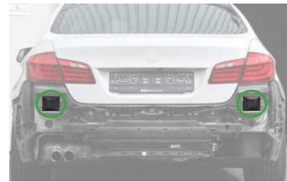
Abbildung 12: Radarsensor für Spurwechsel- assistent hinter Stoßfänger- abdeckung (BMW 5er)
