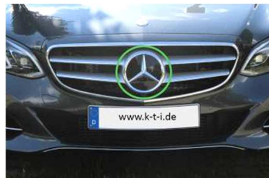
Abbildung 11: Abgedeckter Radarsensor (Mercedes-Benz E-Klasse)
