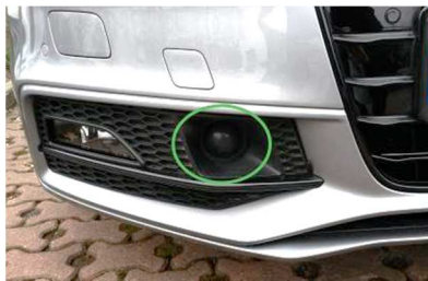
Abbildung 10: Offen eingesetzter Radarsensor (Audi A4)
