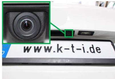
Abbildung 22: Rückfahrkamera in Heckklappe
