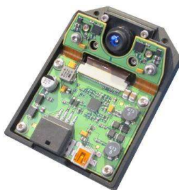
Abbildung 18: Monokamera ohne Gehäuse (am Bsp. Kostal)
