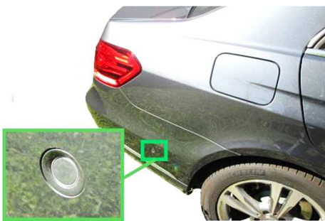
Abbildung 3: Ultraschallsensor für Parkassistenzsystem im hinteren Stoßfänger
