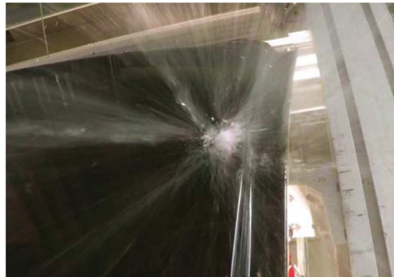
Aufschlag eines Hagelkorns auf einer CfK-Dachhaut
