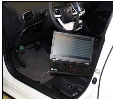
Durchführung einer Diagnose mit einem Mehrmarken-Diagnosegerät
