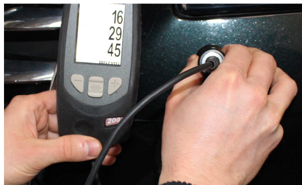
Messung der Lackschichtdicke an einem Kunststoff-Stoßfänger
