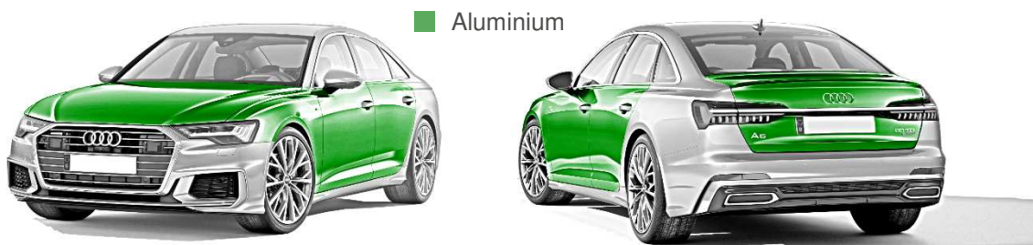
Abbildung 1: Aluminium in der Karosserie-Außenhaut beim Audi A6 (C8)
