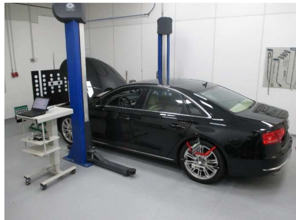
statisches Kalibrieren / Justieren von Fernbereichsradarsensor bzw. FAS-Kamera
