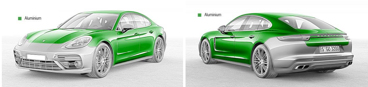
Abbildung 1: Aluminium in der Karosserie-Außenhaut beim Porsche Panamera [1]
