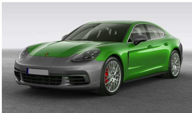
Aluminiumbauteile (in grün) der Karosserie-Außenhaut [1]
