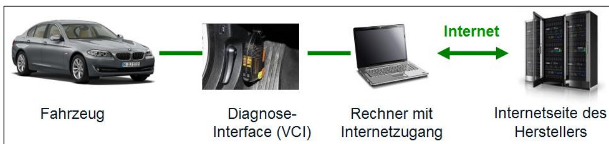
Abbildung 2: Vernetzungsschema Fahrzeug mit Herstellerserver (Pass-Thru)
