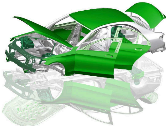
Abbildung 1: Aluminiumteile der Karosserie-Außenhaut (grün) Mercedes-Benz C-Klasse, Typ W205 (Quelle: ATZ Extra)
