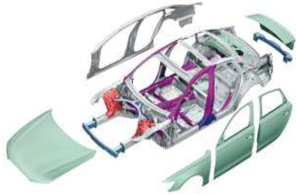
Abbildung 2: Aluminiumteile der Karosserie-Außenhaut (grün) Audi A6, Typ 4G (Quelle: Audi)
