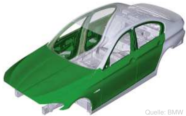
Aluminiumbauteile der Karosserie-Außenhaut (grün) am Beispiel BMW 5er, Typ F10
