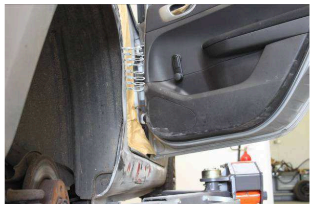
Bild 10: Aufgeschweißte Bits am Kniestück
