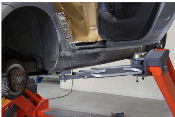
Bild 9: Eingedrückter Radlauf und Kniestück in der Ansicht von hinten
