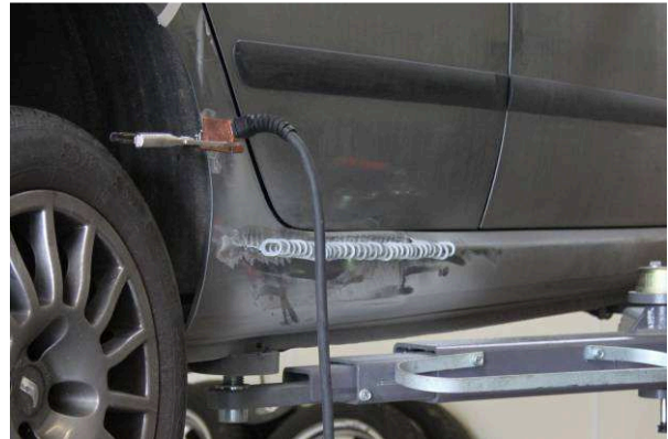
Bild 6: Aufgeschweißte Bits am Schweller
