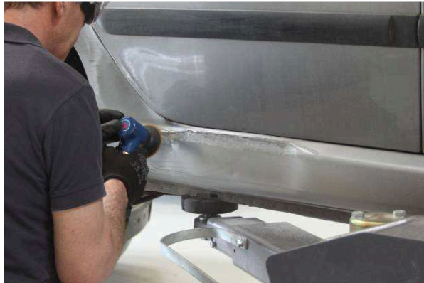
Bild 5: Entfernen der Lackschicht
