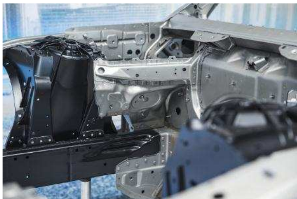
Abbildung 3: Anbindung von Längsträger und Federbeindom an Fahrgastzelle (Quelle: BMW)
