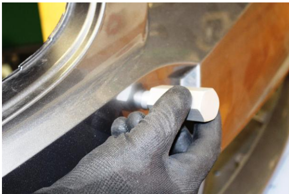
Bild 7: Zentrierdorn an der Stoßfängeraußenseite
