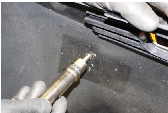
Bild 5: Lochstanzer an der Stoßfängerinnenseite
