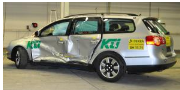
Bild 16: Schäden nach dem zweiten Crash
