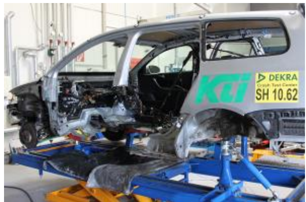
Bild 9: Ersatz des Mitteltunnels
