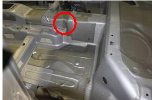
Bild 7: Knick im Mitteltunnel (rote Markierung)
