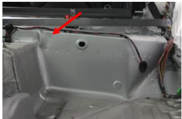
Bild 20: Konsole der Rücksitze nach Zweitcrash
