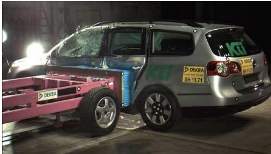
Seitencrash eines fachgerecht reparierten Pkw
