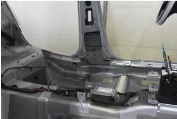
Bild 17: Seitenstruktur nach Erstcrash
