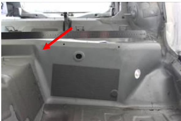
Bild 19: Konsole der Rücksitze nach Erstcrash
