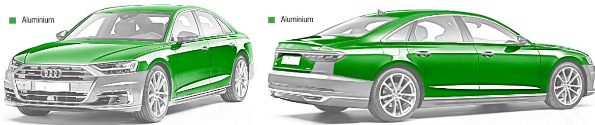
Abbildung 1: Aluminium in der Karosserie-Außenhaut beim Audi A8 (D5)
