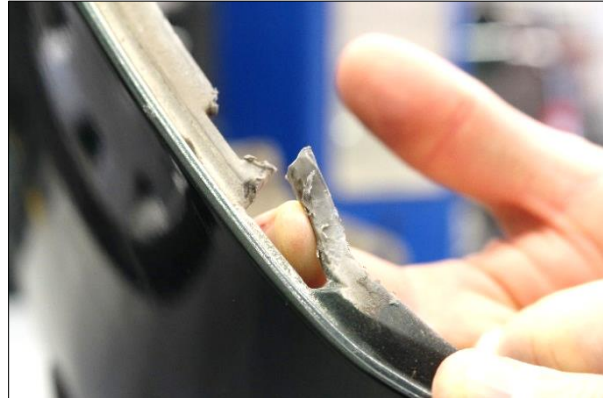
Abbildung 5: Bruch einer Befestigungslasche am Frontstoßfänger
