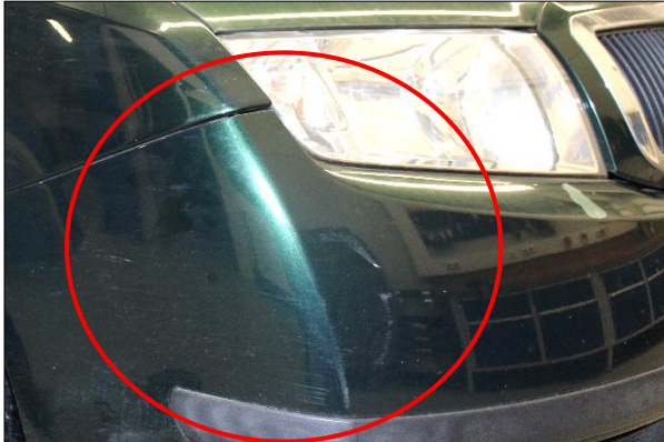
Abbildung 4: Unfallbeschädigter Stoßfänger Skoda Fabia I
