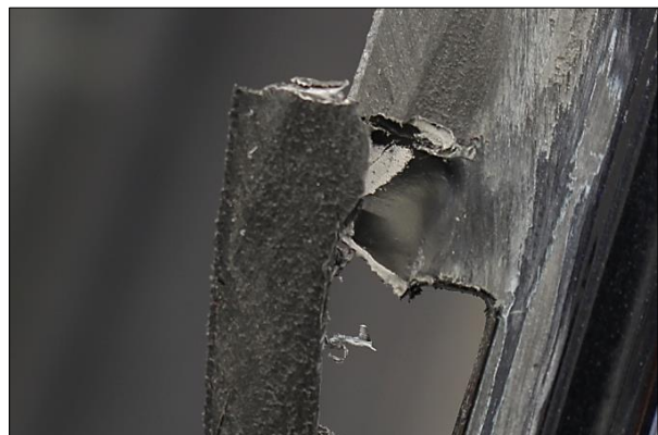
Abbildung 21: Bruchbild einer oberflächlichen Kunststoffverschweißung
