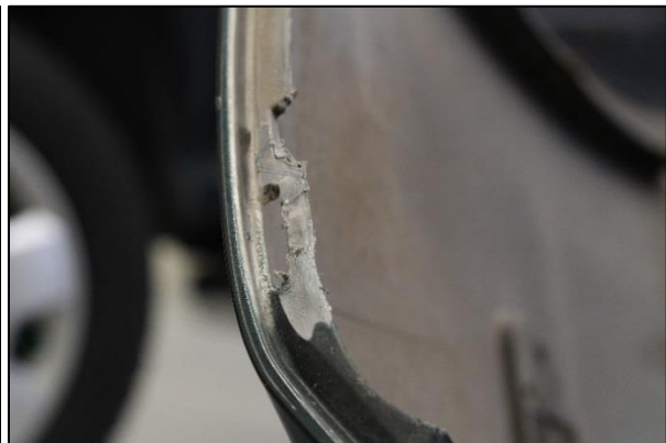
Abbildung 9: Bruchstelle nach dem Schleifen und Reinigen
