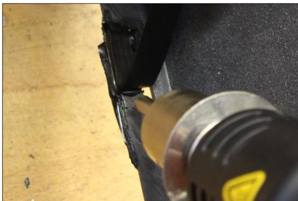
Abbildung 12: Kunststoffauftrag mit der Heißluft-Düse
