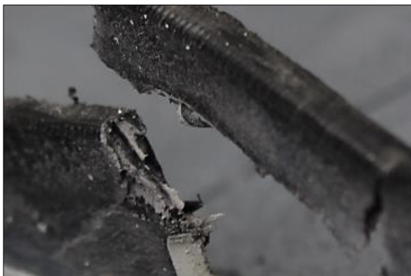
Abbildung 20: Bruchbild einer optimalen Kunststoffverschweißung
