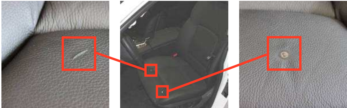
Bild 2: Einriss (links) und Brandfleck (rechts) auf Sitzfläche
