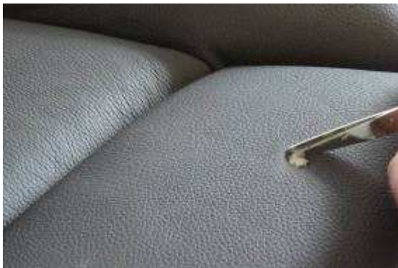
Bild 7: Ausschneiden des beschädigten Leders
