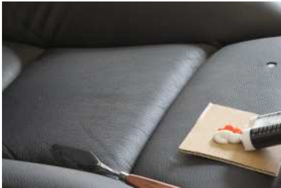
Bild 9: Anmischen des Materials zum Abnehmen der Narbung
