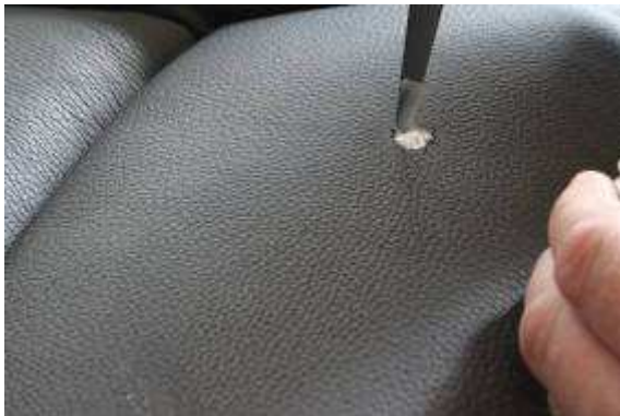
Bild 11: Auffüllen des Brandloches
