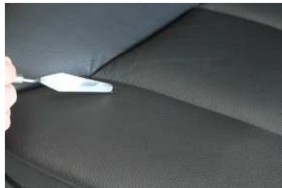
Bild 4: Verkleben der Bruchkanten
