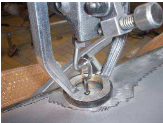
Bild 5: Feinausbeulen mit aufgeschweißten Bits
