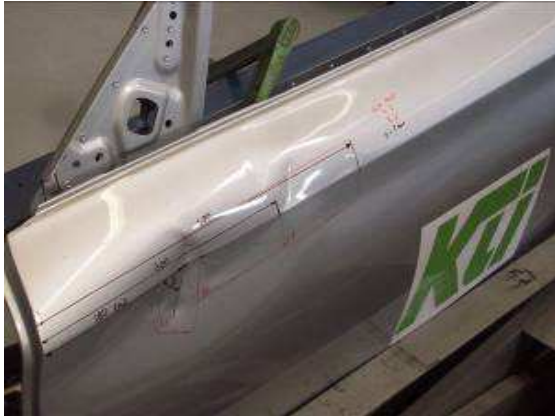
Bild 3: beschädigte Aluminium Tür
