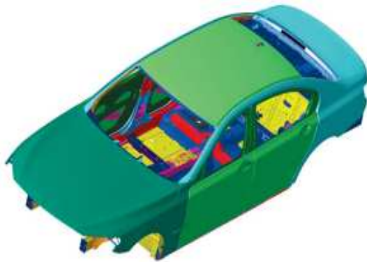
Bild 1: Aluminiumanteile (grün), Außenhaut BMW 7er, Typ F01/F02
