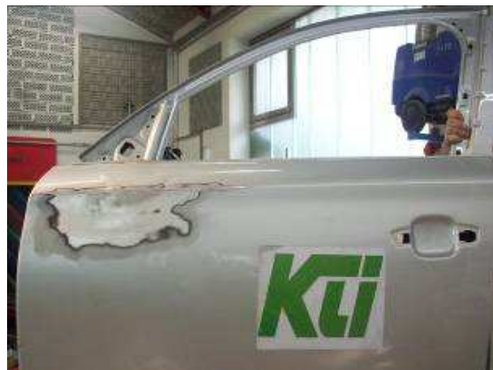
Bild 6: instandgesetzte Tür mit Oberflächenqualität Lackstufe 3
