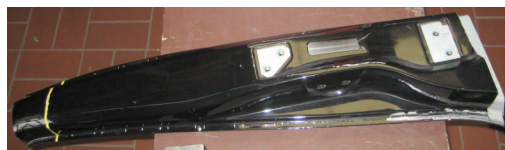
Bild 3: B-Säule mit gelb markierter Schnittfläche
