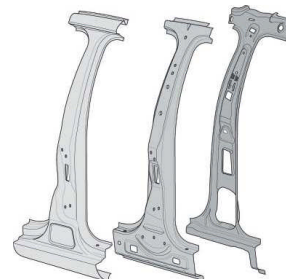
Bild 2: mehrschaliger Aufbau der B-Säule (Quelle: VW Rettungslaufplan)
