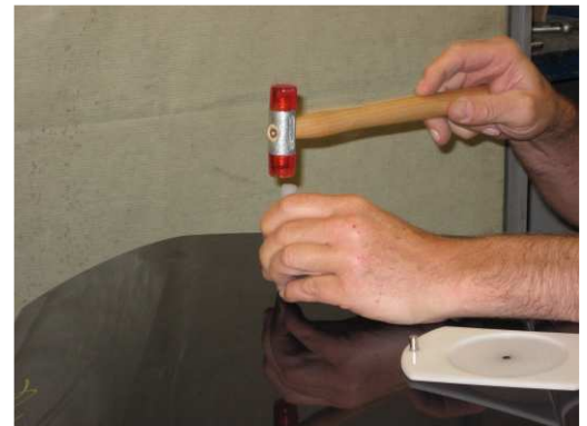
Bild 4 Zurückklopfen der Überhöhungen mit dem Teflonstift
