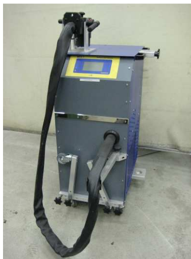
Bild 1: Fahrbarer Wagen mit Kondensatorbank und Touchscreen
