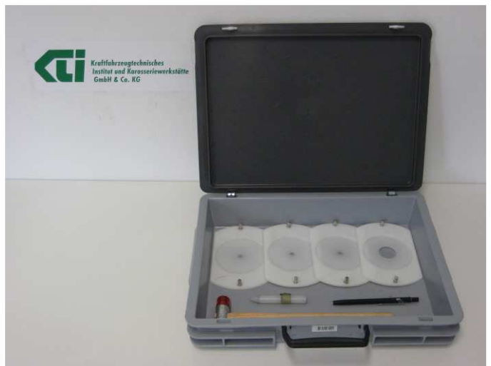
Bild 2: Kunststoffschablonen mit unterschiedlichen Aussparungsdurchmessern und Haltemagneten
