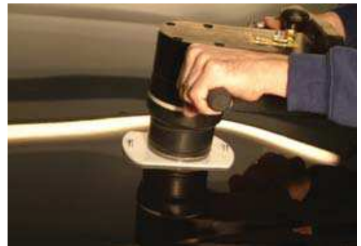
Magnetisch-induktives Ausbeulen mit dem MDR (Quelle: beulentechnik AG)
