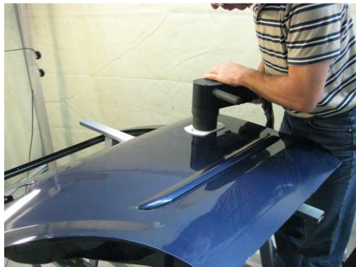
Bild 3 Auf Kunststoffschablone aufgesetzter Werkzeugkopf
