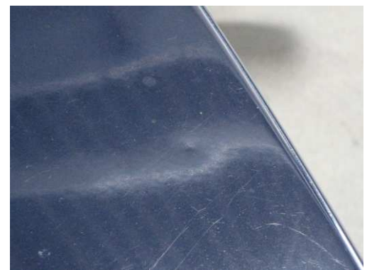
Bild 5 Typischer Hagelschaden mit weicher Form und begrenzter Tiefe an einer Heckklappe
