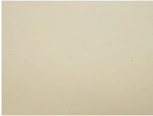
Bild 7: Hinterbrand (Probe 3) nach Klimawechsel- und Salzsprühtest
