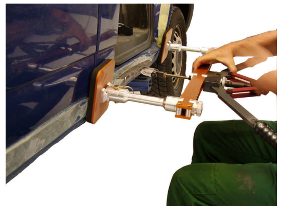
Instandsetzung eines Schwellers mit Außenausbeulsystem
