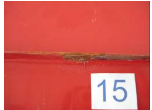
Abbildung 6: Spaltrückseite der unverzinkten Probe nach 9 Wochen realer Witterung
