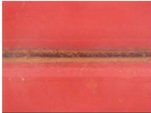
Abbildung 5: Spalt der unverzinkten Probe nach 9 Wochen realer Witterung
