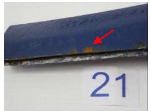
Abbildung 10: Korrosion an der Blechoberfläche der nicht verzinkten Probe (Pfeil)
