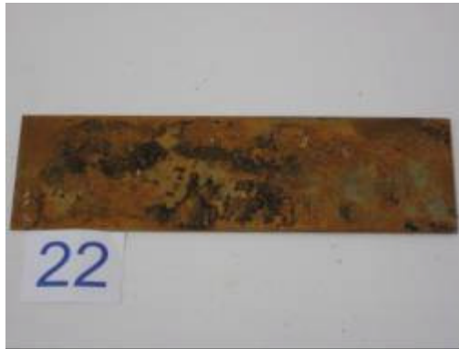
Abbildung 11: Probe nachträglich verzinkt
