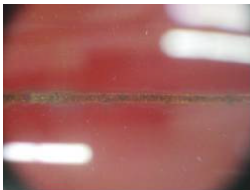
Abbildung 7: Mikroskopische Aufnahme eines Kratzers in der unverzinkten Probe nach Klimawechsel- und Salzsprüh-test
