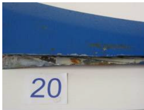
Abbildung 9: verzinkter Radlauf ohne Korrosion
