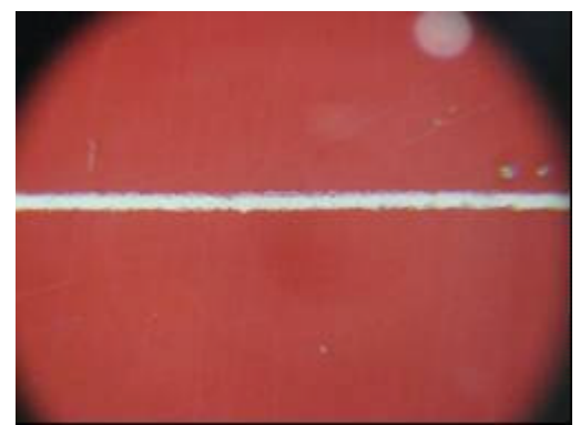
Abbildung 8: Mikroskopische Aufnahme eines Kratzers in der nachverzinkten Probe nach Klimawechsel- und Salzsprüh-test
