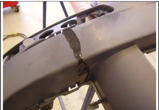
Bild 6: Reparaturstelle von außen
