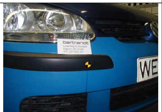
Bild 4: markierte Anstoßstelle unrepariertes Frontend
