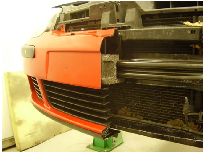
Aufbau eines modernen Vorderwagens nach Fußgängerschutzrichtlinien
