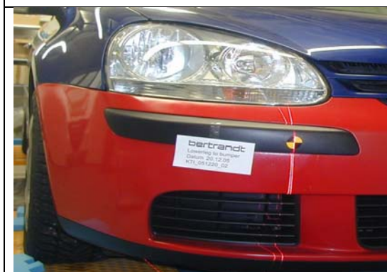
Bild 3: markierte Anstoßstelle repariertes Frontend
