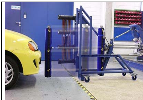
Bild 1: systematische Schussapparatur für Beinimpaktor
