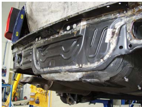
Abbildung 10: Heckblech mit Schlossaufnahme
