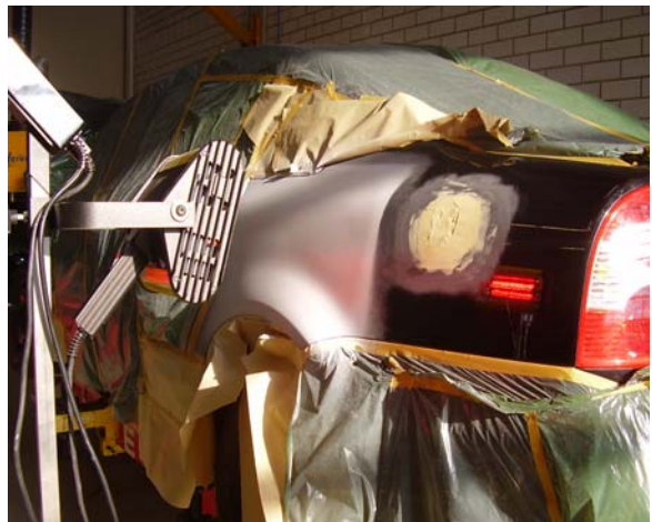
Spachtelstelle am Fahrzeugseitenteil
