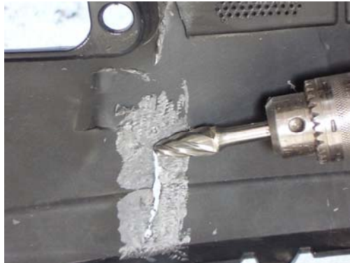
Abbildung 3: Auffräsen des Risses (Rückseite)
