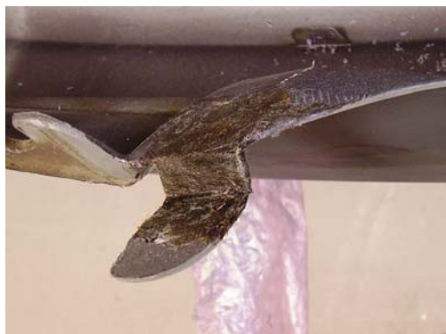
Abbildung 13: Einseitig verschweißte Befestigungslasche
