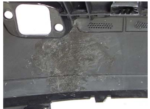
Abbildung 6: Fertige Reparaturstelle (Rückseite)
