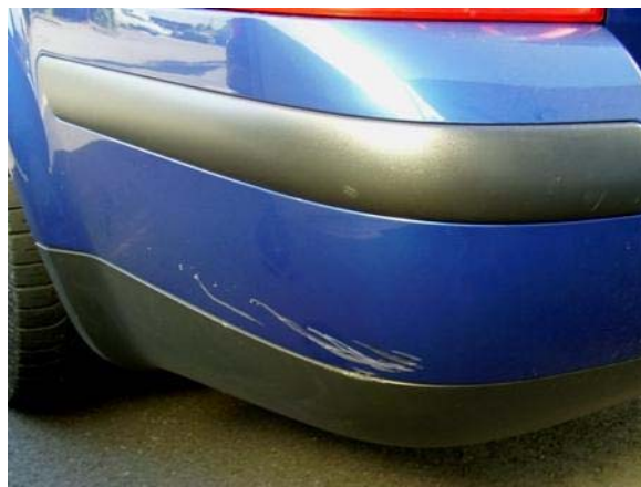
Beschädigungen der Stoßfängerhülle
