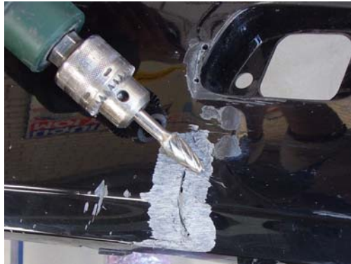
Abbildung 7: Auffräsen des Risses (Vorderseite)
