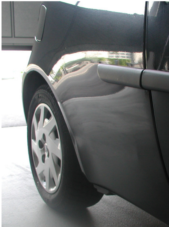
Fiat Punto: Streifschaden im Bereich der Seitenwand
