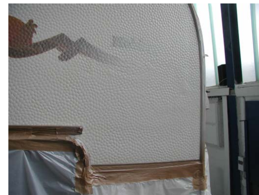
Abbildung 6: Versehen des Bereiches mit Beispritzverdünnung
