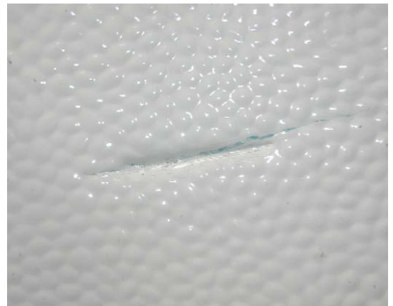
Detail: Wohnwagen mit Beschädigung in der Seitenbeplankung
