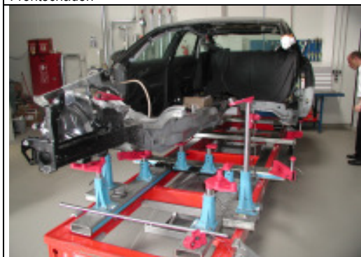
Abbildung 3: Karosserie mit herausgetrennten Teilstücken auf Richtbank
