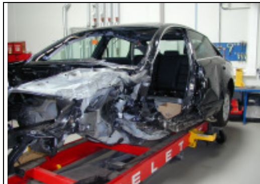
Abbildung 1: Audi A6, Frontschaden
