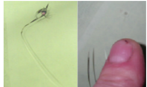
Bild 3: Steinschlagart: Bienenflügel mit Riss (vorher-nachher)
